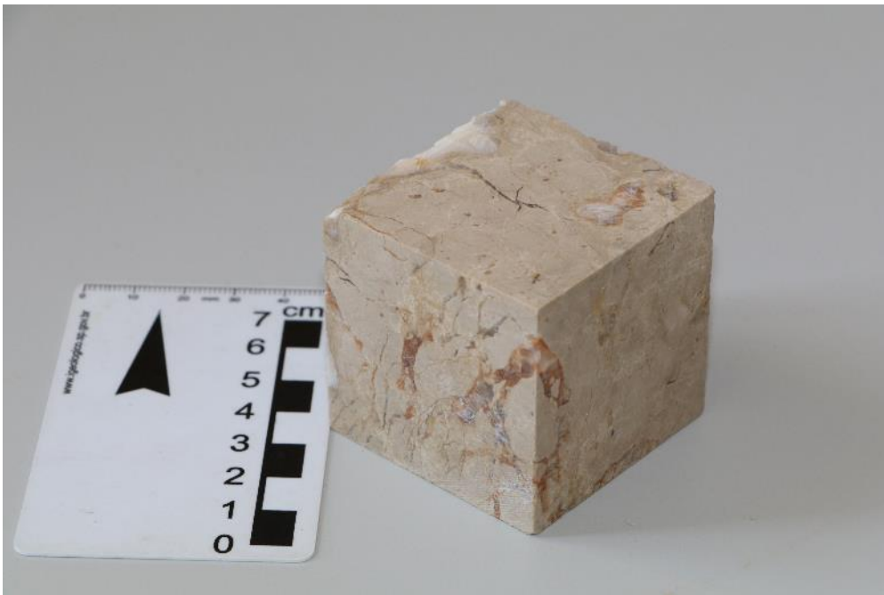
Figura 3 - Provete cubico com 5 cm de aresta a partir do qual se corta a talisca para elaboração da lâmina delgada.
