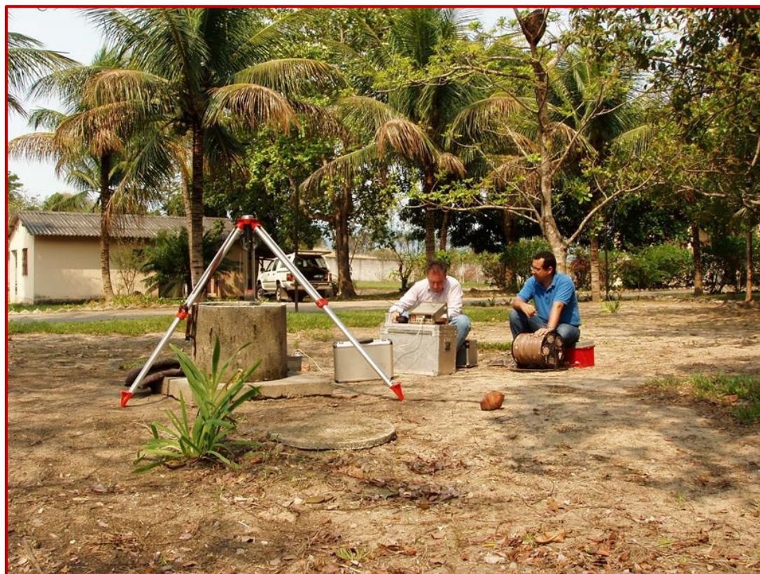
Medição da temperatura num furo no estado do Rio de Janeiro, Brasil.
