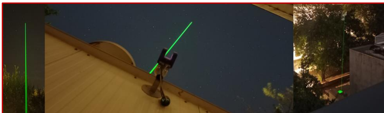
O sistema lidar em funcionamento durante a noite que permite observar a emissão do feixe laser a 532nm de comprimento de onda.
