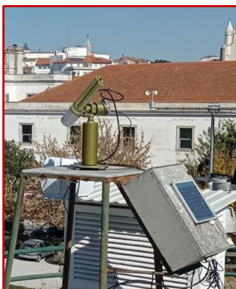
O sistema Cimel para determinar vapor de água, ozono e aerossóis na coluna atmosférica usando uma combinação de filtros espectrais e geometrias de observação
