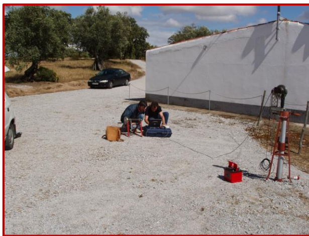
Medição da temperatura num furo para estudos paleoclimatológicos em Évora.
